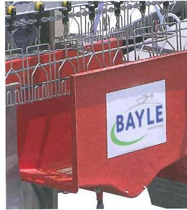
Les chaînes d'abattage BAYLE de type "COMPACT" répondent à des cadences d'abattage de 150 à 1500 poulets par heure, suivant les équipements proposés.
